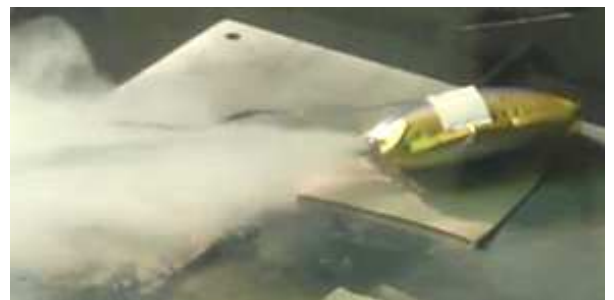
Abb. 1: Zersetzung von kleinem Li-Ion Akku. Ausdehnung der Zelle und Abblasen („Venting“). Stichflammenbildung steht kurz bevor.
